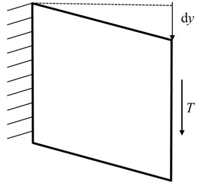
Énergie de déformation élastique d'une poutre soumise à un *effort de torsion*
